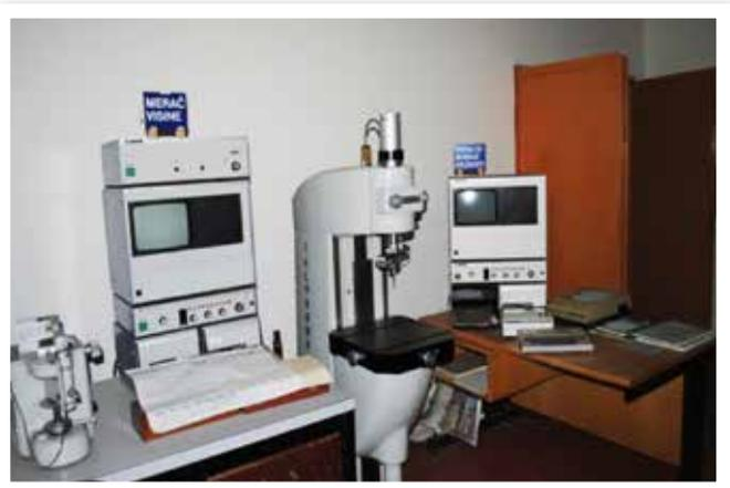
Maschine zur Prüfung der Kreisförmigkeit und der Raughigkeit,
