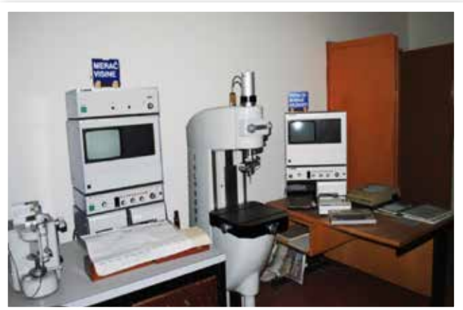
Machine d'examen de la circularité et d'âpreté: HOBBSON & TAYLOR (Angleterre)
