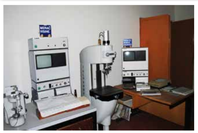
Macchina per il controllo di circolarità e rugosità, produttore: la HOBBSON e TAYLOR (Gran Bretagna)
