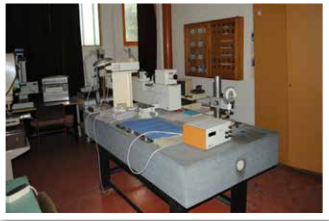
Macchina per il controllo tridimensionale, produttore: la Mitutojo, Giappone
